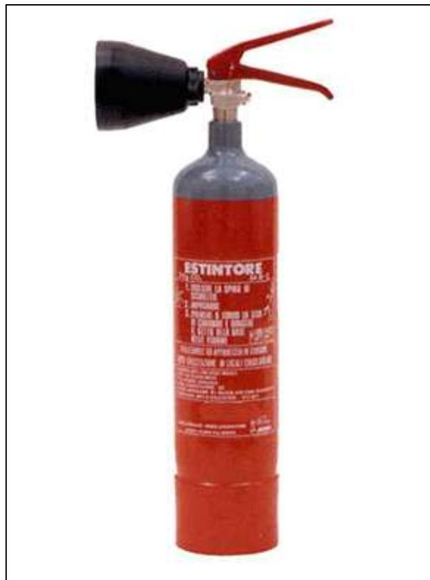
Al momento dell'azionamento, l'anidride carbonica contenuta nel corpo dell'estintore, spinta dalla pressione propria interna, pari a circa 55/60 bar (a 20°C), raggiunge il cono diffusore dal quale, attraverso il passaggio obbligato in un filtro frangigetto, si espande con una temperatura di circa -78 °C sotto forma di "neve carbonica o ghiaccio secco".
