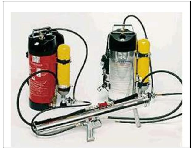
Le due camere di alimentazione sono rifornite di aria sotto pressione e di acqua tramite due connessioni, diverse e distinte, di cui quella per l'aria si trova nella parte inferiore del tubo, in prossimità del grilletto, e quella dell'acqua sulla parte superiore del tubo. Tali tubazioni conducono all'estremità opposta a due contenitori specifici, da portare sulle spalle dell'operatore. Il contenitore dell'acqua ha la capacità di 12 litri; quello dell'aria è una usuale bombola da 7 litri.
