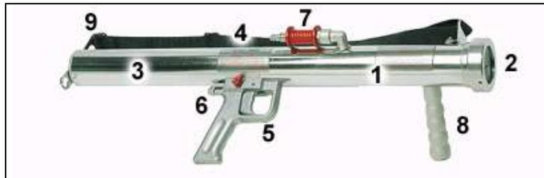
L'attrezzatura di lancio dell'estinguente dell'IFEX contiene nel suo interno circa 1 litro di agente. Questo viene lanciato, tramite la pressione del grilletto, in 2 centesimi di secondo, con una nube di goccioline aventi una velocità media di 120 metri al secondo (che equivarrebbero a oltre 400 km/h). Per ricaricare dal serbatoio pressurizzato di rifornimento occorrono circa 3 secondi, tempo che consente di valutare l'effetto del colpo piazzato e la direzione preferibile per il successivo.
