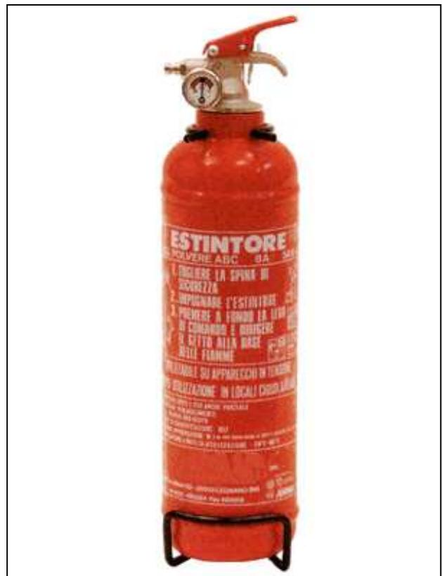
L'azione esercitata dalle polveri chimiche consiste essenzialmente nell'inibizione del materiale ancora incombusto tramite catalisi negativa, nel soffocamento della fiamma e in una azione endogena per abbattere subito la temperatura di combustione.
