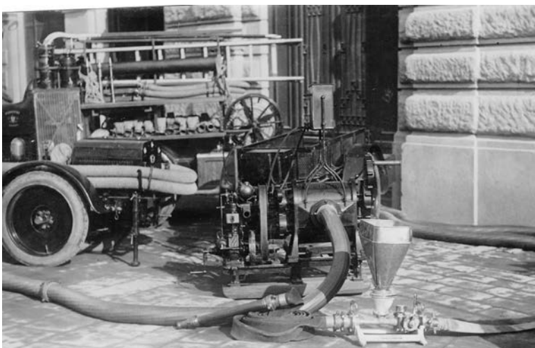
Anni '30 - Materiali tecnici - Attrezzature antincendio (la tramoggia serviva per produrre la schiuma) e puntelli meccanici
