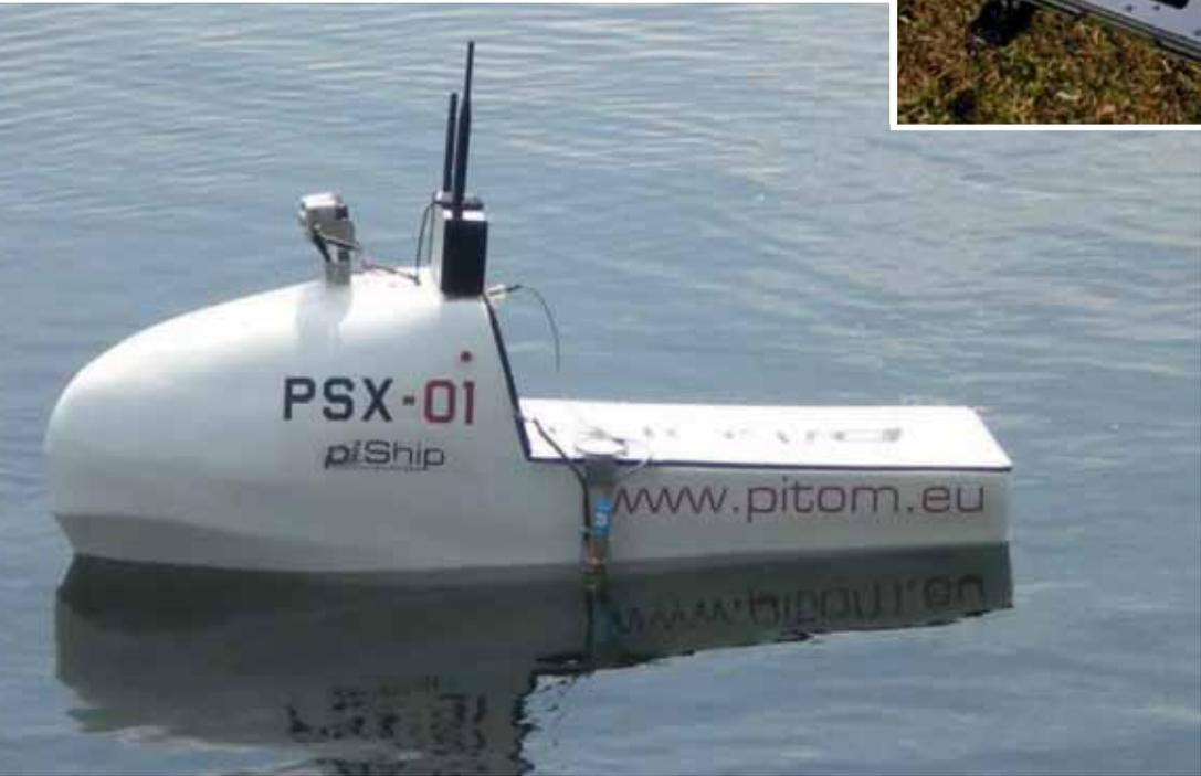
Sopra da sinistra, progettazione e realizzazione di autopiloti e interfacce uomo-macchina su specifiche esigenze; Ground Control Station per il controllo mezzi unmanned. A sinistra, mezzi marini: ispezioni visive, termiche, batimetrie, qualità acque
